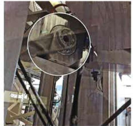
**02** Durch einen Wechsel zu Zykloidgetrieben erwartet das französische Unternehmen eine deutliche Verlängerung der Lebensdauer der Getriebe
